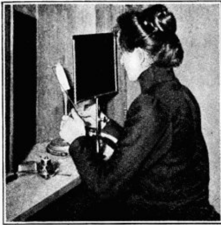
Fig. 99. Das Formen und Härten des Glühkörpers.
