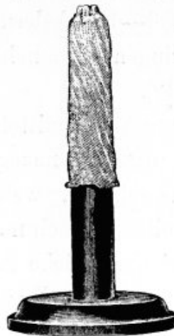
Fig. 82. Falsch geglätteter Glühkörper.
