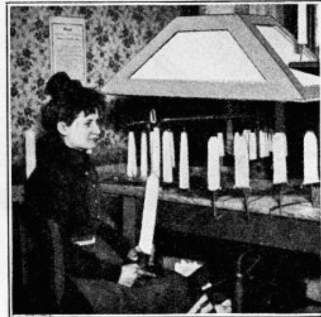
Fig. 92. Veraschen der Glühkörper.
