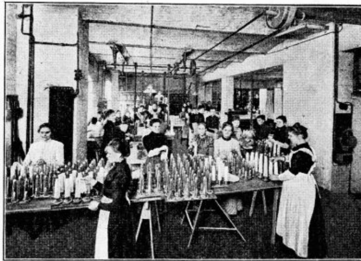
Fig. 70. Trockenraum für die imprägnierten Strümpfe. Im Vordergrund Bretter mit Trockengläsern.
